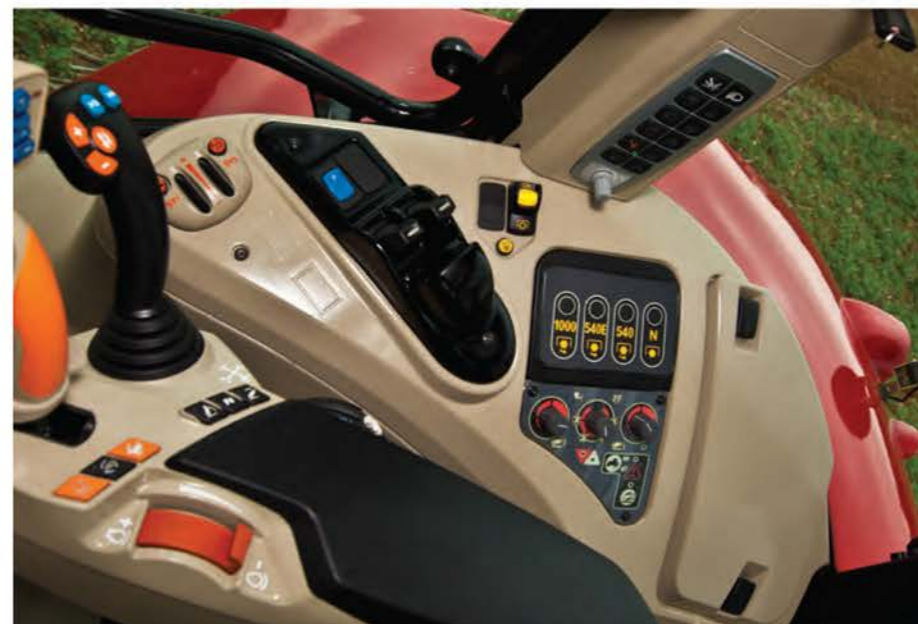
Выбор скорости ВОМ, селектор ВОМ и переключатели автоматического включения эргономично сгруппированы на правой панели в зоне доступа оператора.
