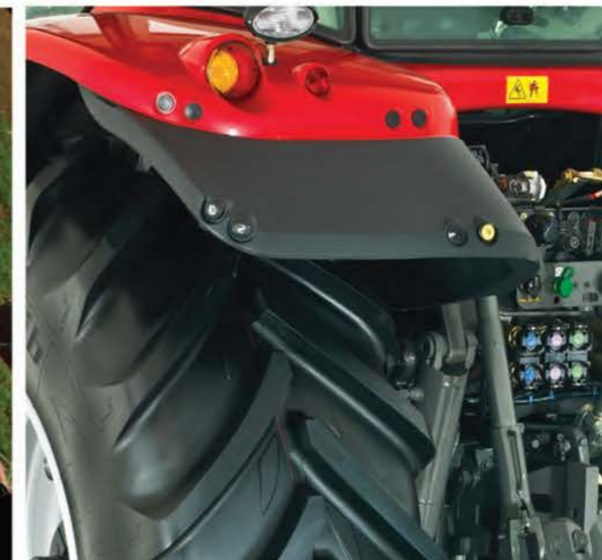
Дополнительные кнопки управления ВОМ на крыле позволяют управлять ВОМ, находясь вне кабины. Также с помощью кнопки управления ВОМ можно отрегулировать число оборотов двигателя — весьма удобная функция, например, при использовании цистерны с раствором.
